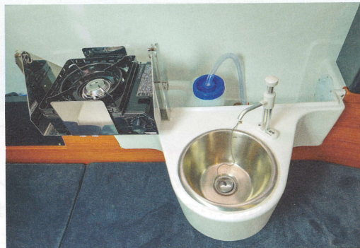
上：このシンクは宙に浮いて(張り出して)おり、その下に荷物などを置いておくことができる。限られた空間をうまく利用している
