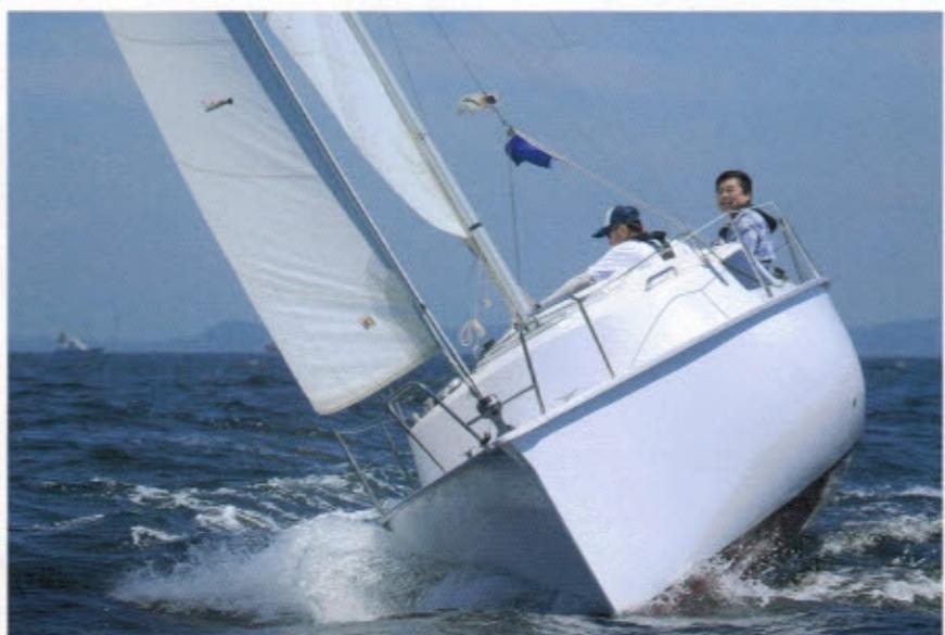
ミジップ断面は梢円形。直立時の水線幅が狭く、フォームスタビリティーがある。いわゆる「粘り腰」で、バラストの軽さを感じさせない
