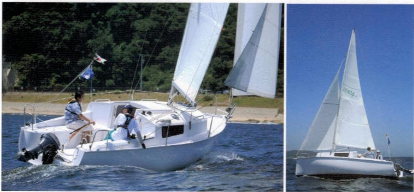
左：中排水量だが走りは軽い。ラストハング前の抵抗が低いのだろう、容易にハルスピードに達する。リラックスしたセーリングフォームだ
