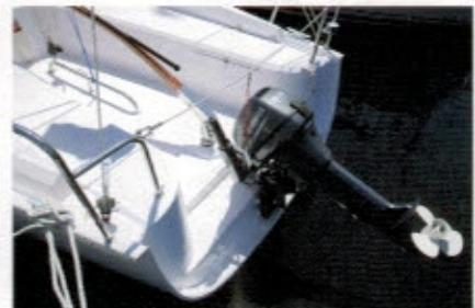
オープントランサムは、ウインドベーンの取り付けなどが容易で、打ち込んだ波の抜けがよい。ガンネルの張り出しがよく分かる
