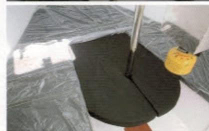
上：テーブルと、キャンピングガスコンロ用の前後左右に利くジンバル。マストサポートのどの位置、どの向きにも取り付けられる
