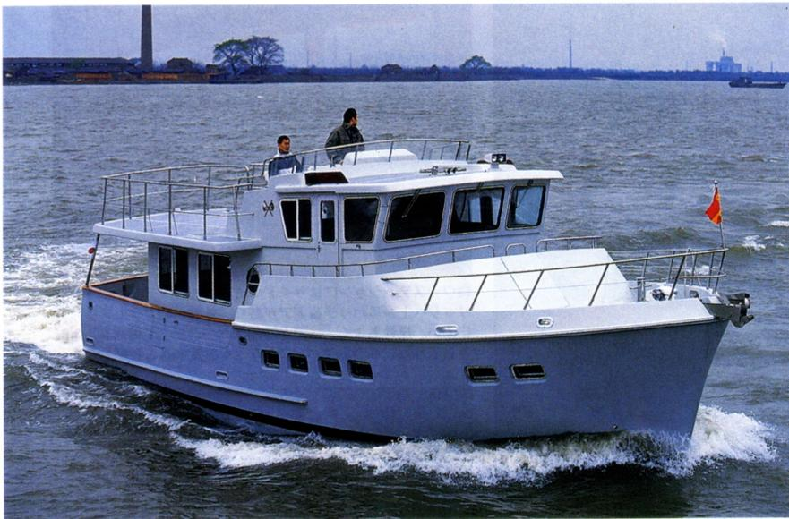
旋回中のソロ47。旋回半径は2艇身弱と大きめだが、バンクもなくスムーズな旋回ができる。本来はフライブリッジにマストが装着される
