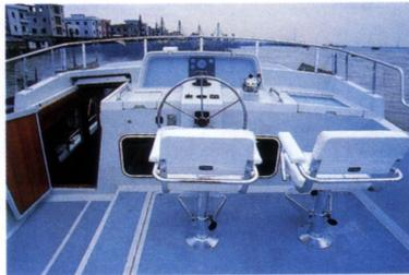
ヘルムステーションはフロアが1段高くなっている。ナビゲーターシートの前にチャートケースが、ドライバーシートの左手に小物入れが、ラットの前にスラスターのスイッチとコンパスがあるだけで、メーターパネルを含めて極めてシンプルな構成だ
