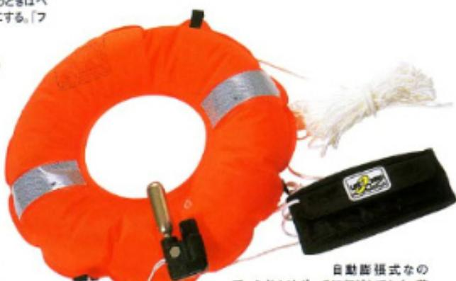
自動膨脹式などで、ふだんはポーチに収納しておく。落水者に向けてポーチごと投げれば、着水後数秒で膨らむ。投げる際は付属のロープの端を船にくくりつけるか、誰かがしっかりと握ておく。沿海までの船検査対応品。
